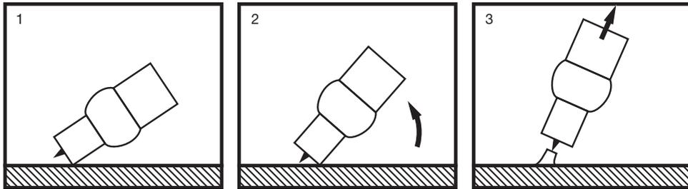
1. Поставьте керамическое сопло горелки на изделие, не касаясь при этом вольфрамом детали. Держите расстояние 2-3 мм. Откройте вентиль горелки.
